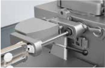
↑ Carga de tripa con mano automática y embudo de torsión
