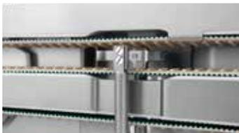
↑ Unidad de separación con módulo de separación
