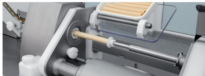
Cambio de tripa con cabezal revólver doble o triple: mientras se produce con un embudo de torsión puede colocarse ya la tripa siguiente en el segundo embudo. Para realizar un cambio de tripa, el operario acciona ahora el mando a dos manos. El cabezal revólver bascula y se desplaza linealmente a la posición de embutición. El cambio de tripa se realiza en una posición ergonómica inclinada hacia el operario.
