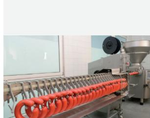
Proceso continuo con clipado y colgado totalmente automáticos de anillos enteros y medios en envolturas de plástico, fibrosas y de colágeno. Solución en línea modular formada por embutidora al vacío, línea de colgado AL y clipadora Poly-clip FCA 100.
