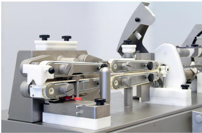
↑ Separación mediante una solución de 2 cintas y sensor
